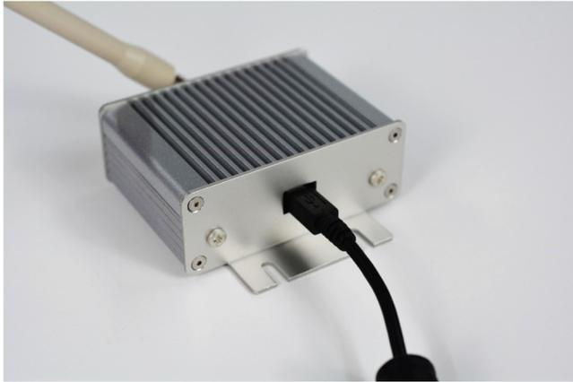
付属 USB メモリの USB¥ML64 を PC で運用するフォルダにコピーし、この中の AdxfConf.exe を実行します。PC のデバイスマネージャーを開き、親機の COM ポートを確認し、この値を、以下の COM NUMBER の箇所に設定します。
